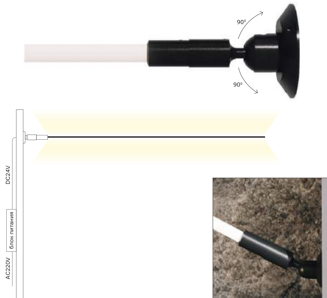
Сечение неона 13 мм x 13 мм для неона на креплениях-шарнирах
