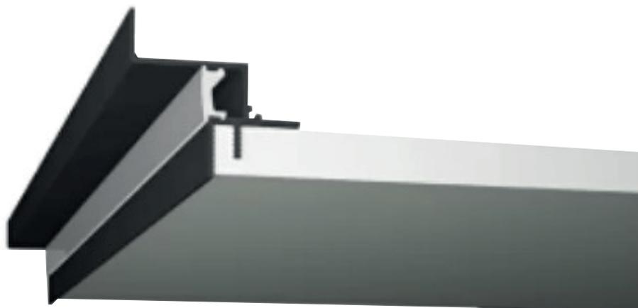
Предназначен для монтажа потолка из гипсокартона с безрамным примыканием и подсветкой (теневого потолка с подсветкой). Оснащен пазом для установки светодиодной ленты и матовым светорассеивающим экраном.
