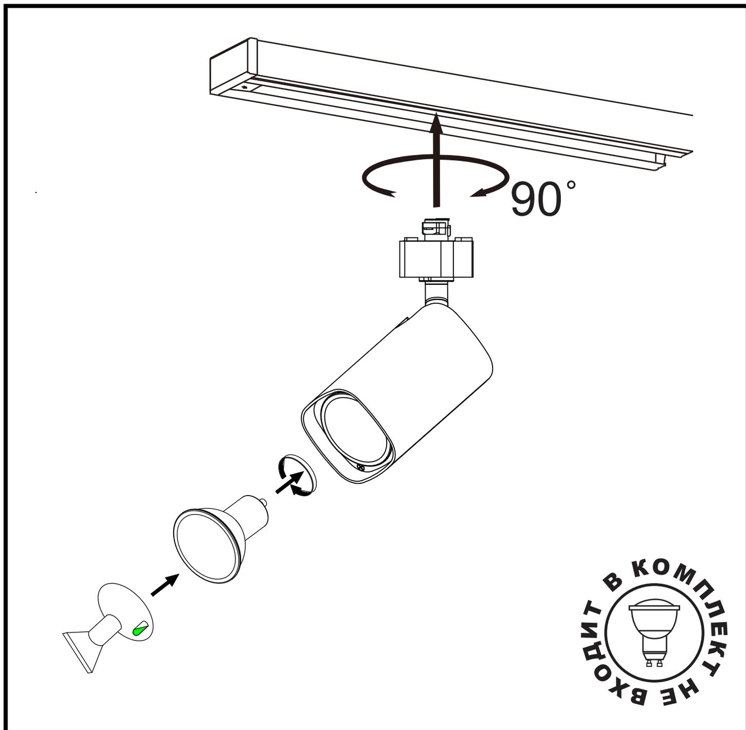
**ВНИМАНИЕ.** Все работы по монтажу шинпровода и установке светильников, замене ламп и техническому обслуживанию следует проводить при отключенном напряжении питания шинпровода.
